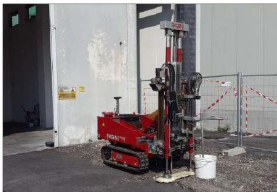
Esecuzione dell'indagine penetrometrica dinamica superpesante D.P.S.H.
